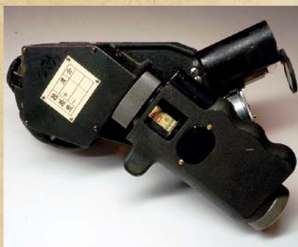
写真2 戦時中に日本海軍の航空機で使われていた「気泡六分儀」。夜間、水平線が見えなくとも星の地平高度を測ることができた。
